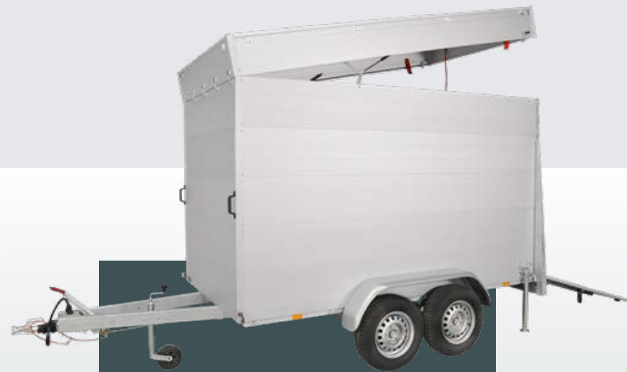
VT4 mit einer Innenhöhe von 188 cm. Anbindeschienen in 5 Höhen, inklusive 8 Stück Bindeaugen.
