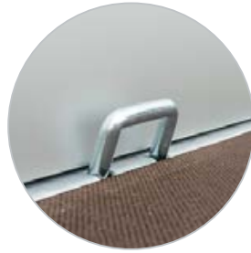
8 Bindehaken an der Innenseite der Ladeplattform
