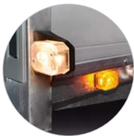
Vorder- und Seitenmarkierungsbeleuchtung
