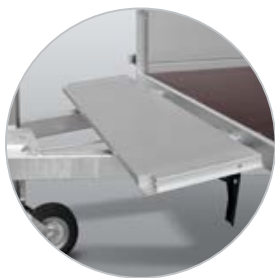
Vorderbordwand kann auf der Deichsel aufliegen
