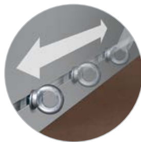
Bindschiene auch an der Innenseite der Ladefläche
