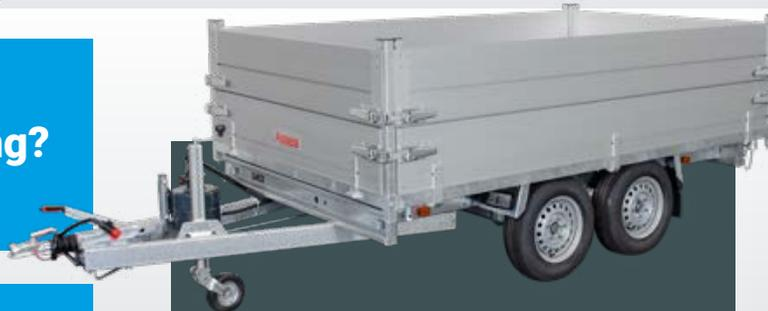
Transportieren Sie mehr Volumen dank der Aufsatzbordwände, einem beliebten Zubehör. Es entsteht eine Ladehöhe von 65 cm.
