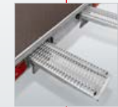
Unterm Ladeboden integrierte Auffahrampen
