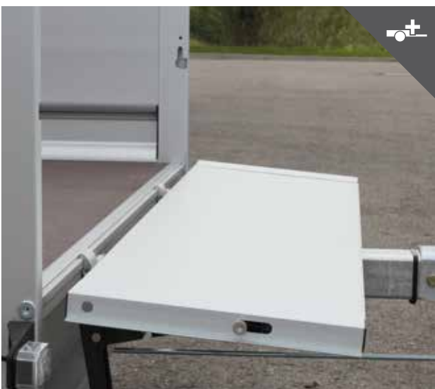
Bordwand an der Stirnseite abklappbar für langes Ladegut
