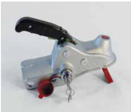
Diebstahlenschutz Safety Ball mit abschließbarer Kugelpkupplung
