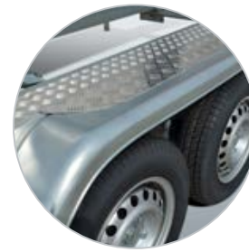
Kotflügel mit extra Verstärkung
