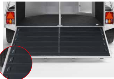
Sicherer Einstieg durch den Gummibelag mit Trittleisten und Seitenstopp auf der Hinterklappe.
