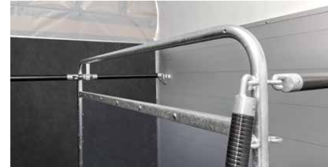
Sicherer Transport durch die bewährte Böckmann Trennwand und das vorne um 15 cm höhenverstellbare, Sicherheitsboxenstangensystem mit Anbinderingen.
