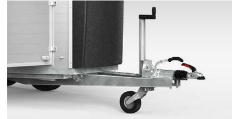
Bequemes Rangieren durch das automatische Stützrad – extra lang mit handlicher Kurbel und bei jedem Wetter perfekt zu bedienen.
