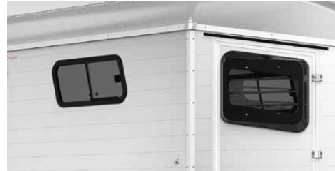
Frischlucht durch die großen, blendfreien 5-Wege-Fenster (nach vorne, hinten, oben, unten sowie komplett aufstellbar) mit Sicherheitsgitter und zusätzlichem Schiebefenster.
